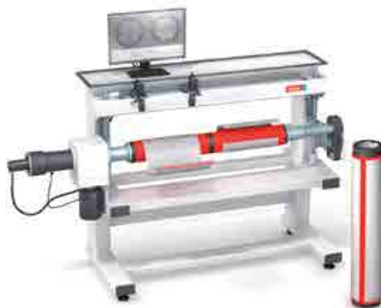
Koncepcja tesa® Twinlock zapewnia ekologiczny i wielorazowy produkt do montażu płyt fleksograficznych
